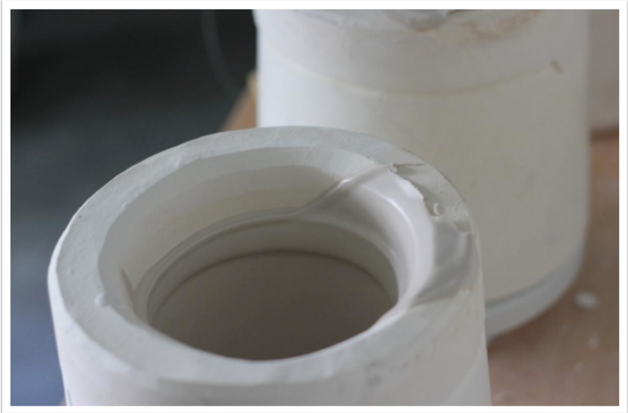
Le coulage consiste à verser l'argile sous forme fluide (barbotine) dans un moule en plâtre.
